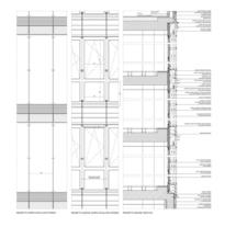
copertura fotovoltaica composta da serramento in alluminio e specchiature vetrate dotate di celle fotovoltaiche interposte; studio di ricerca condotto, nell'anno 2000, con Schüco International, Schüco International Italia, Siemens AG, Saint Gobain Glass Italia;
