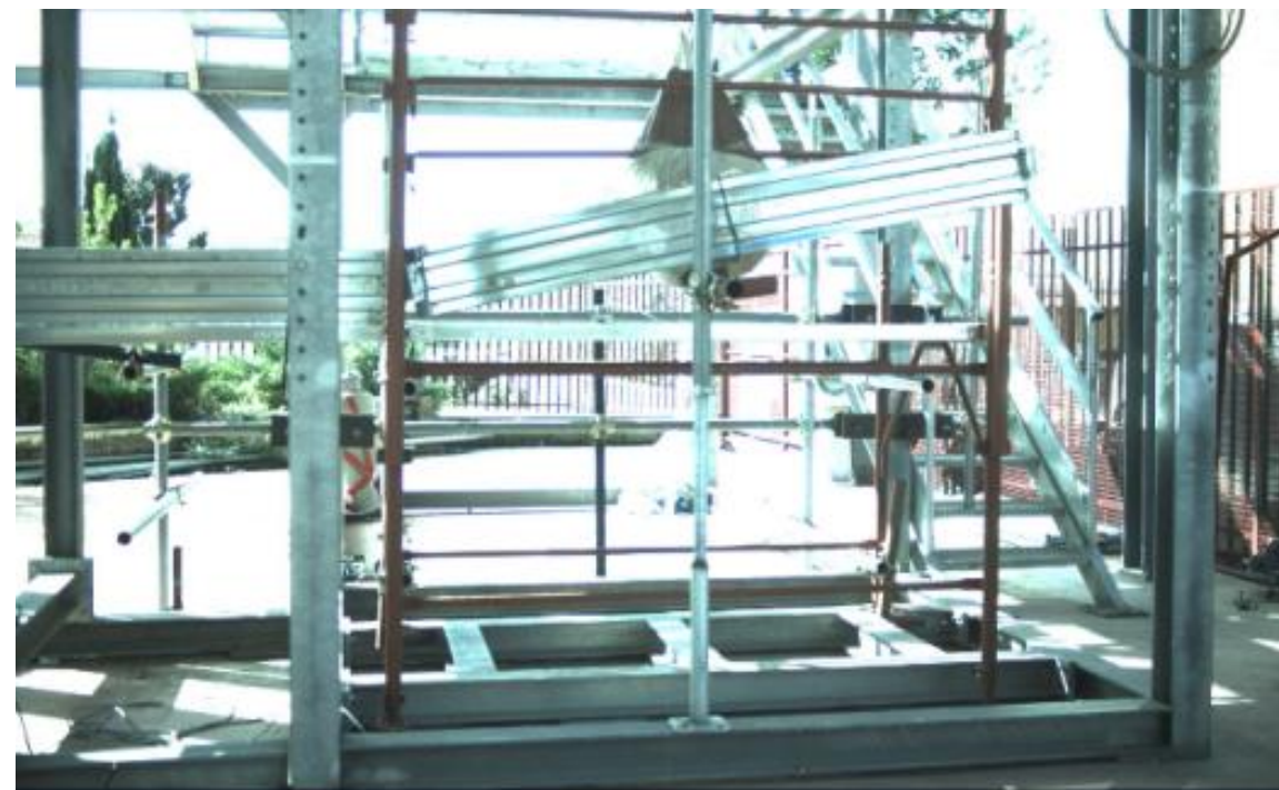
Criticità nella connessione montante tavola fermapiede
