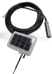
Traccia le variazioni del livello delle falde acquifere dovute a frane profonde. Misura le variazioni del battente idraulico in cm o mm.
