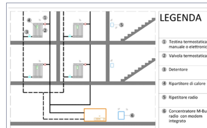
Figura 1- Schema d'impianto a colonne dotato del sistema di contabilizzazione indiretto del calore
