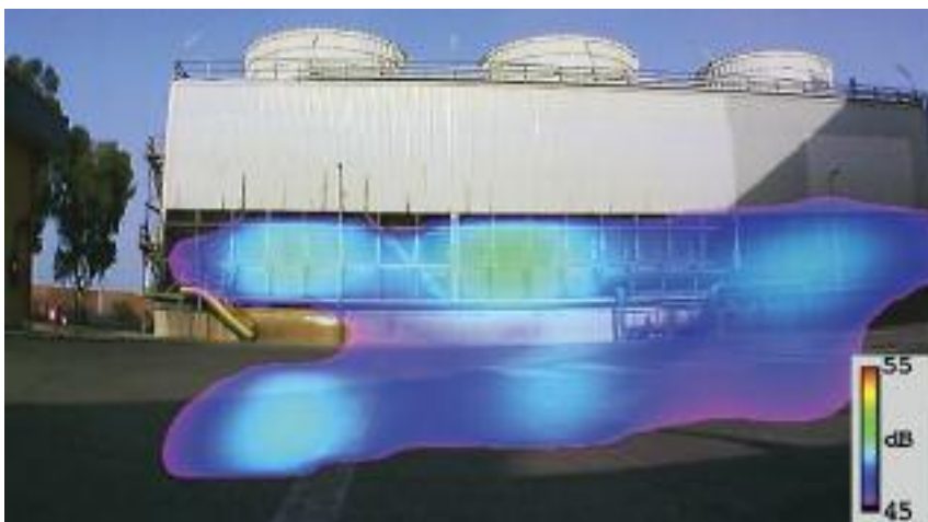
Fig. 2 - Esempio di riflessione del rumore su un piazzale presso il quale è posta una torre evaporativa
