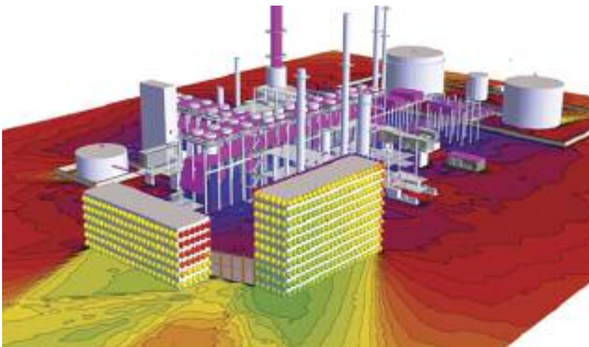
Fig. 6 - Esempio di modellazione con software di simulazione di propagazione del rumore SoundPLAN
