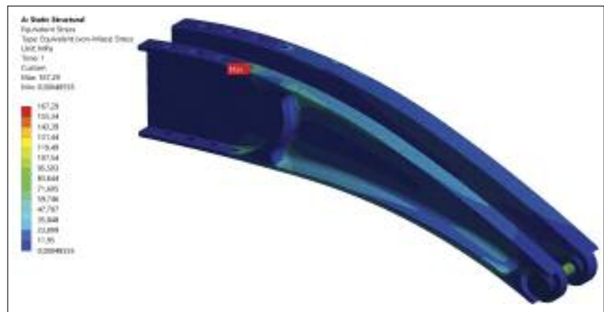
Distribuzione delle tensioni sul supporto del rullo della guida inclinata
