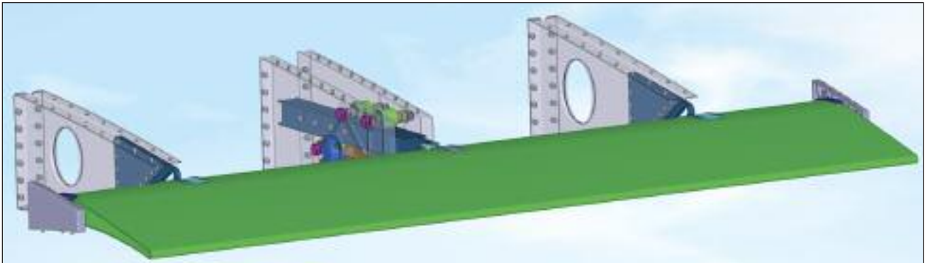
Design 3D degli elementi costituenti il sistema di estrazione del flap
