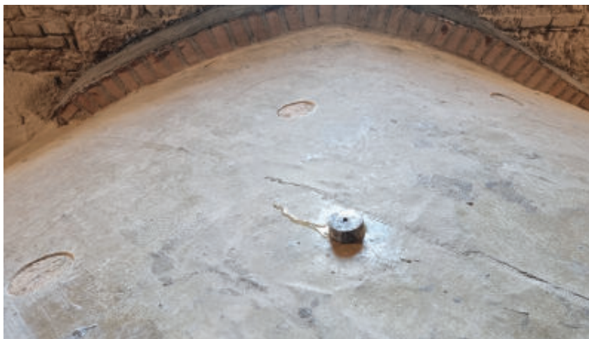
Figura 3 - Il campo prove per verificare l'efficacia degli interventi sul Santuario di Rivotorto dopo quaranta anni dall'applicazione avvenuta nel 1984.
