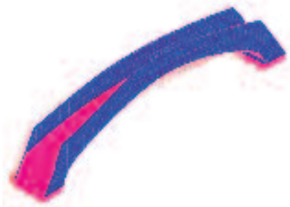
Figura 15: rappresentazione 3D del modo di vibrare n° 5 della struttura
