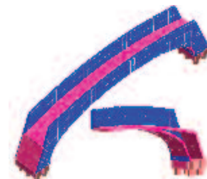
Figura 13: mesh del modello FEM della struttura principale. A fianco dettaglio degli elementi SHELL della parte in elevazione della spalla
