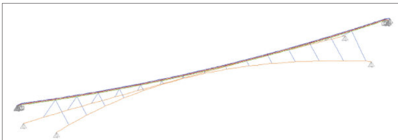
Schema tridimensionale delle funi che compongono il ponte: cavi spiroidali chiusi f34 (impalcato) verde, cavi spiroidali chiusi f34 (parapetto) rosso, cavi spiroidali aperti f20 (sicura) blu, cavi spiroidali aperti f26 (stabilizzazione) arancione, cavi a trefoli f12/14 (pendini) ciano (immagine Area Progetto).
