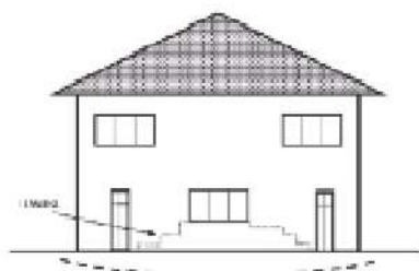
Figura 5 - Il ritiro del terreno sottostante il fabbricato è causa di sollecitazioni anomale delle fondazioni con evidenti fessurazioni alle pareti.
