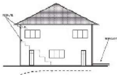
Figura 3 - La presenza della terrazza crea un'area soggetta a minore evaporazione, creando una dissimmetria con la parte a sinistra del fabbricato.
