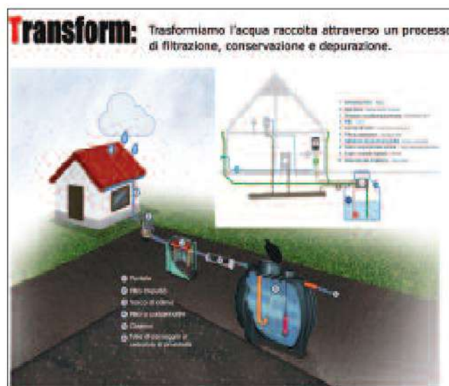
Figura 11: rappresentazione schematica del sistema di serbatoi per il recupero dell'acqua piovana del progetto STOP
