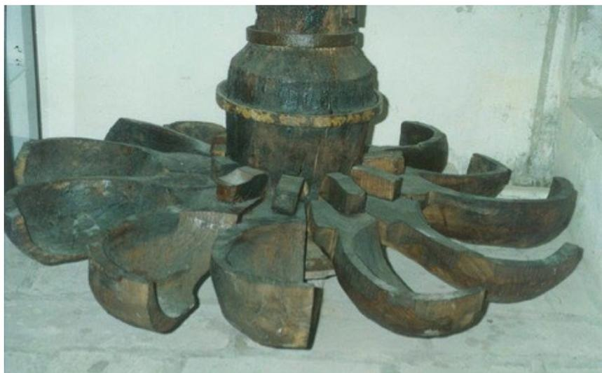
Figura 2 - Ruota idraulica orizzontale, chiamata ritrecine, rinvenuta presso il molino Contessa a Casalecchio di Castel Bolognese (Immagine di E. Badioli)
